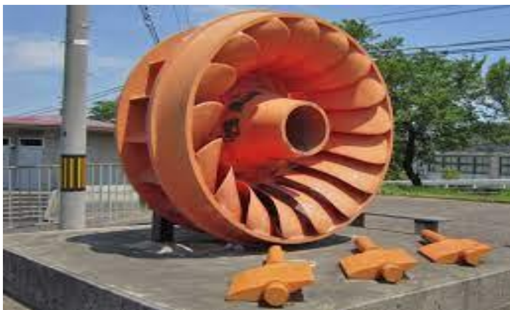
Рис. 1. Рабочие колеса радиально- осевые (РО). гидротурбин , Фрэнсиса
