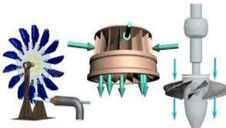
Рис. 2. Сравнение режимов работы гидротурбин Пелтона, Фрэнсиса и Каплана
