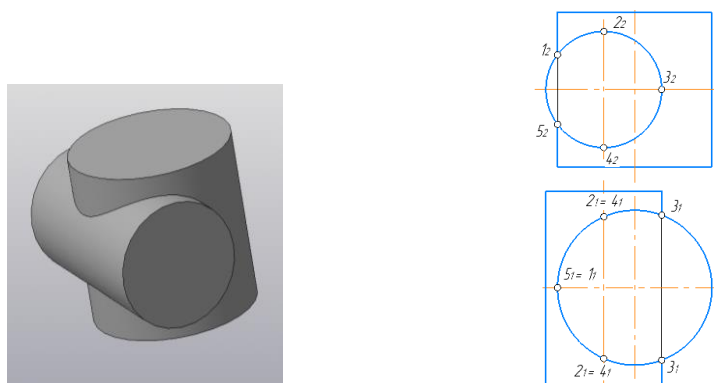
Рисунок 1. Пространственная модель взаимно пересекающихся цилиндров и ее 2D проект в фронтальной и горизонтальной проекциях.
