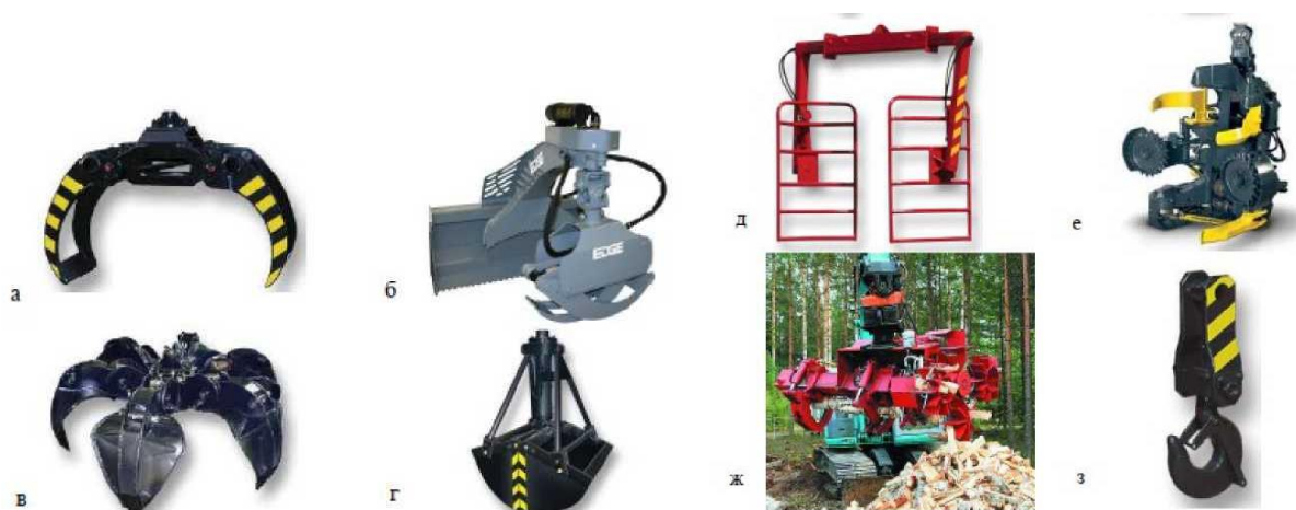
Рисунок 7 - Рабочие органы лесных манипуляторов: а - грейферный захват; б - захват с упором для погрузки хлыстов; в - грейферный многочелюстной захват; г - двухчелюстной грейферный ковш; д - захват для рулонов бумаги; е - харвестерная головка; ж - навесной древокол; з - грузовой крюк
