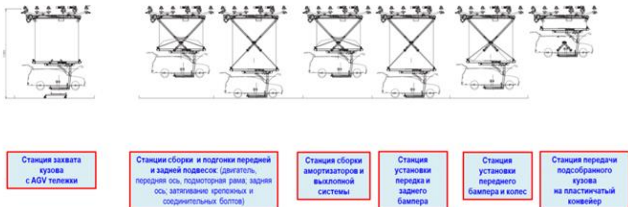
Рис. 2 – Последовательность процессов на линии сборки шасси
