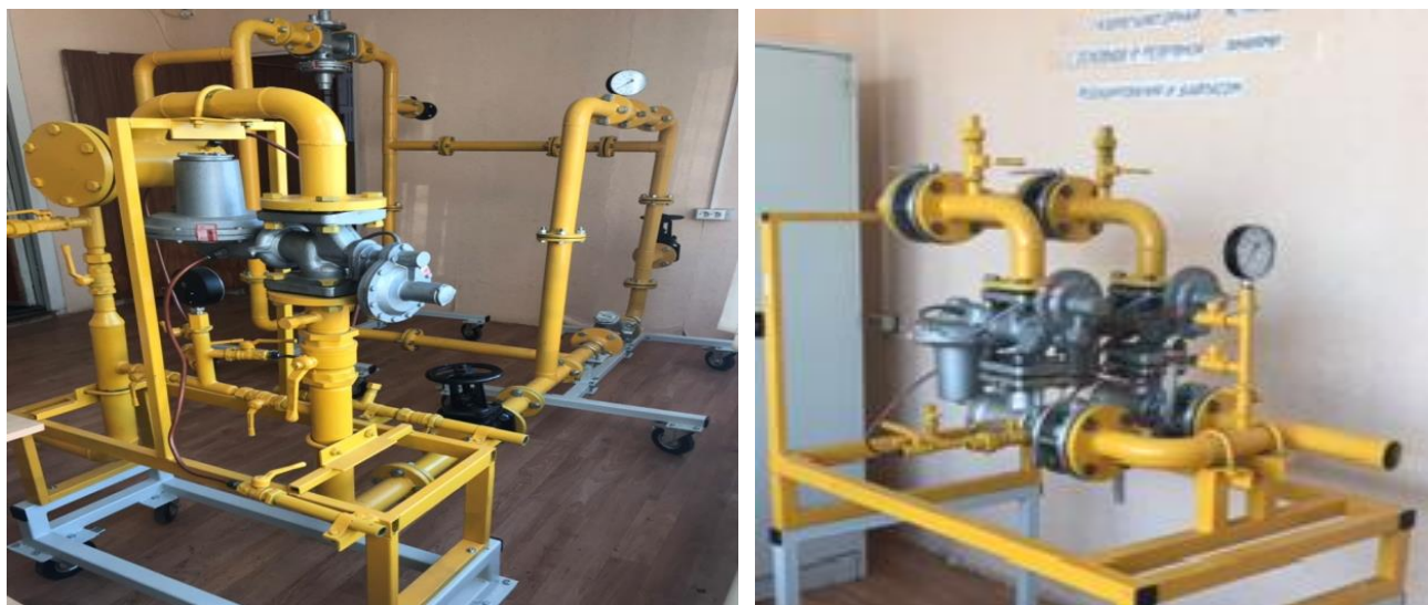
Рисунок 1 – Стенд-тренажер «Монтаж оборудования газовой распределительной сети» и стенд-тренажер «Газорегуляторная установка с основной и резервной линиями редуцирования и байпасом»
