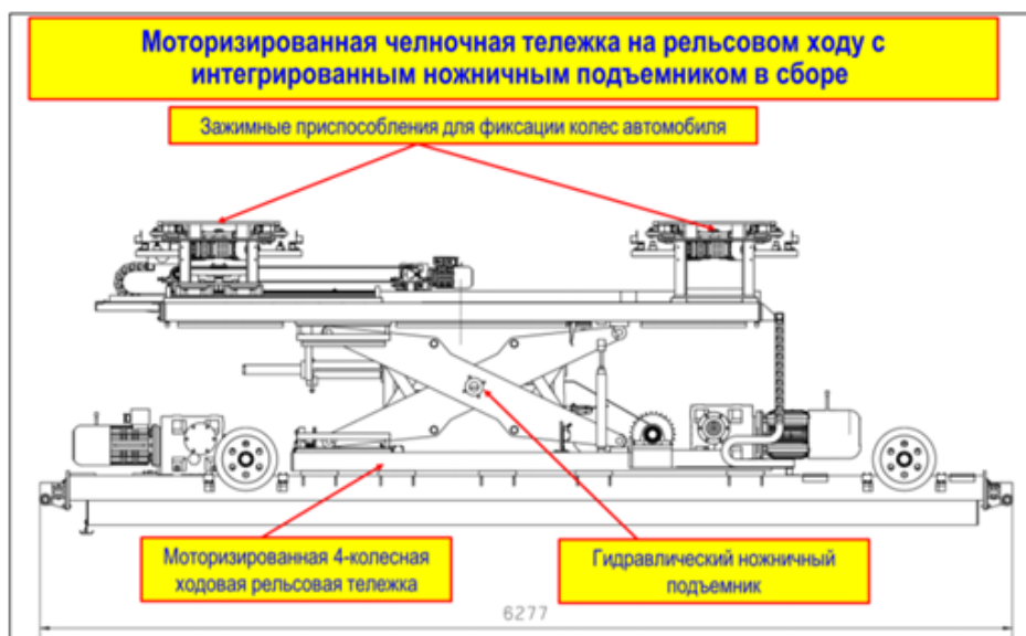
Рис. 3 - Моторизованная челночная тележка на рельсовом ходу с интегрированным ножничным подъемником в сборе
