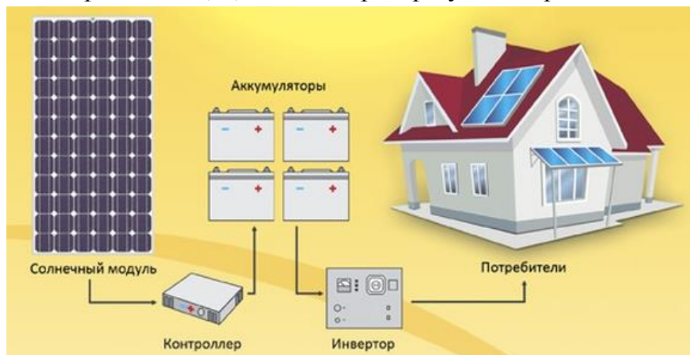
Рисунок 1 – Схема работы солнечной батареи
